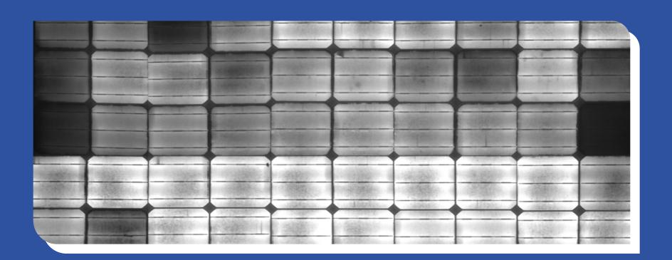
El ensayo de electroluminiscencia permite identificar defectos, imperceptibles visualmente de los módulos, que pueden afectar el desempeño futuro del sistema fotovoltaico. Estos defectos pueden haber sido causados por problemas durante la producción del panel, manipulación inadecuada durante el transporte o la instalación y degradación inesperada por condiciones ambientales luego de la instalación.
